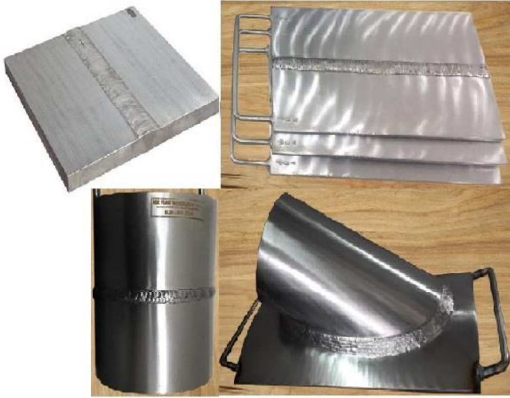
شكل رقم ٩٧: العينات التي سيستخدمها الطالب في الاختبار.
