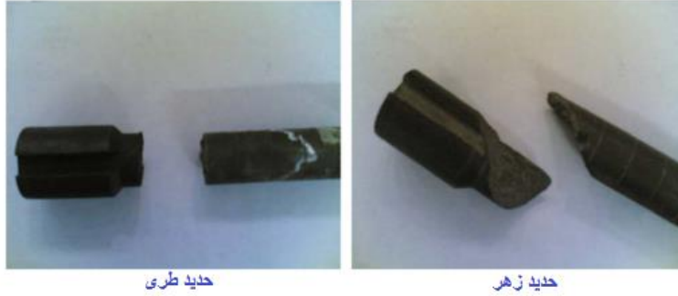
شكل رقم ٧٥: أشكال كسر عينات من معادن مطيلة ومعادن قصفة في اختبار الالتواء
