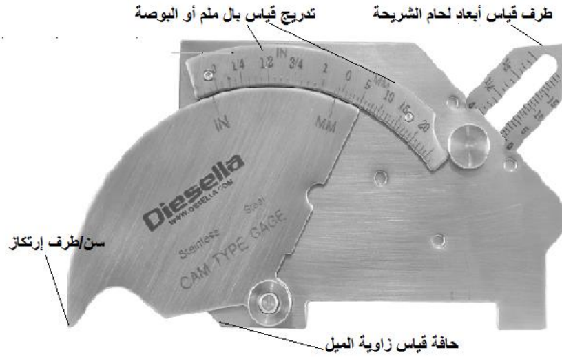
شكل رقم ٩٢: أداة قياس شكل وأبعاد اللحام
