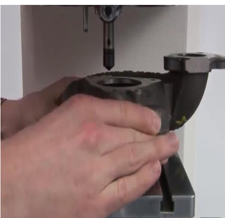
٦. ضع العينة (الشاحن الجبري) على السندان أسفل المسنن لنبدأ الاختبار
