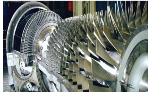
شكل رقم ٥٦: معادن صلادة تصنع منها ريش المحركات التوربينية وهياكل الدبابات
