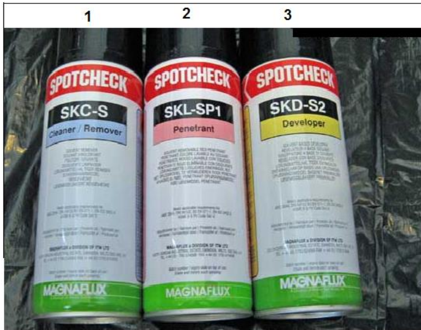
شكل رقم ٩٦: السوائل الثلاثة المستخدمة بطريقة الاختبار بالسوائل النافذة.
