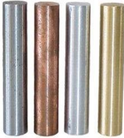
شكل رقم ٤٥: عينات قياسية متساوية الطول والقطر من الحديد الطري والنحاس الأصفر والأحمر والحديد الزهر
