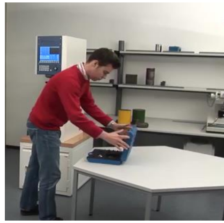
٣. اختر مسنن مناسب من حقيبة الاختبار
