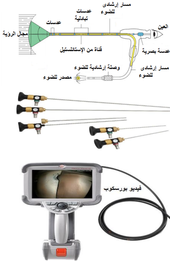
شكل رقم ٩٠: التركيب الداخلي لأداة البروسكوب.
