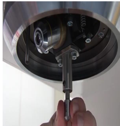
٤. ركب المسنن الذي تم اختياره بالجهاز
