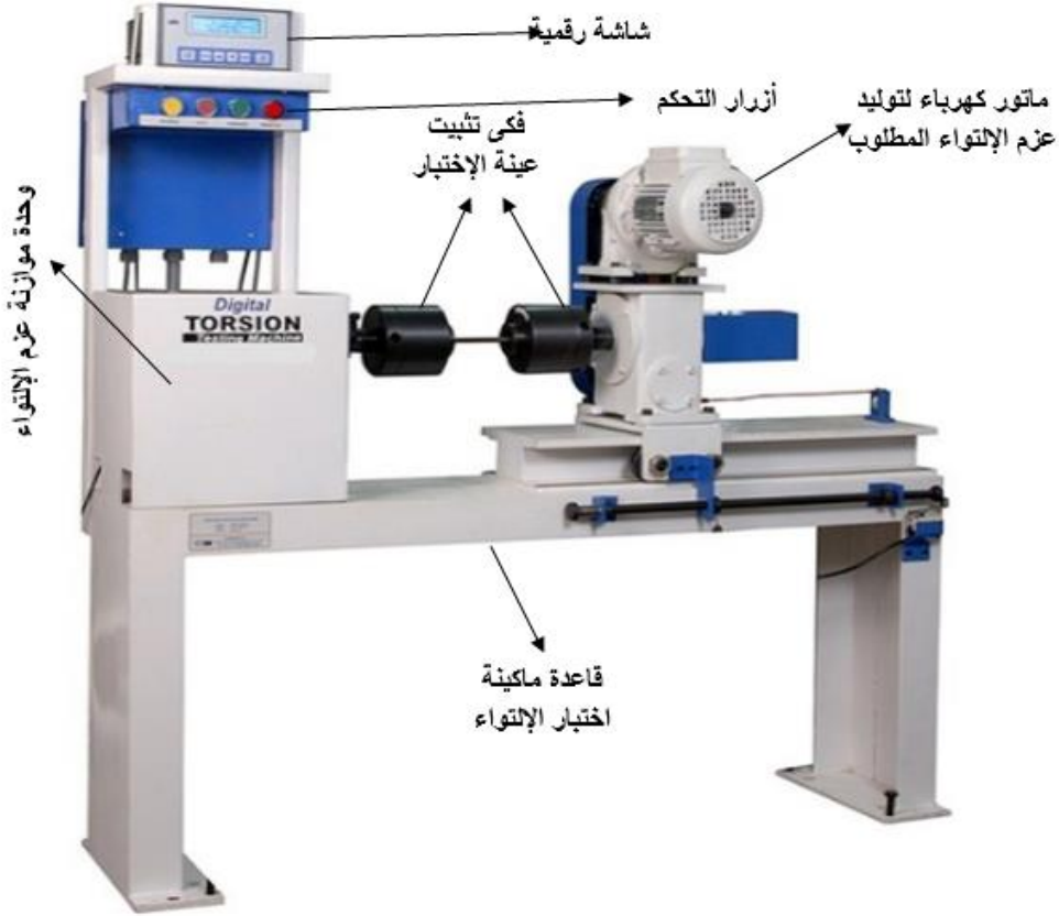
شكل رقم ٧٣: ماكينة اختبار الالتواء.
