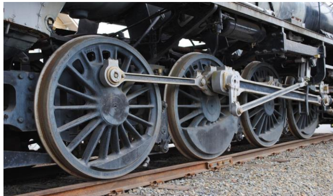
شكل رقم ٥٨: عجلات القطار لها صلادة عالية تقاوم التآكل
